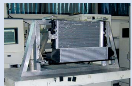
Testing engine cooling modules on a long-stroke shaker at Valeo Thermique Moteur, La Verrière/France
